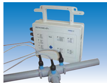
L'électrofusion (automatique) et son résultat
