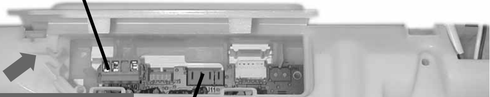
Passage pour les fils du thermostat d'ambiance et de la sonde extérieure.
