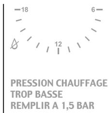
La chaudière s'est mise en sécurité parce qu'elle a détecté un manque d'eau dans l'installation.
