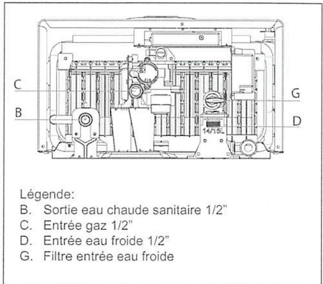
L'appareil est équipé d'un filtre "G" sur l'entrée eau froide.
