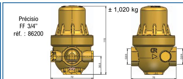
**PRÉCISIO multi-fileté (chapeau composite ou laiton) est livré avec 2 raccords multi-filetés réversibles à ÉCROU TOURNANT**
