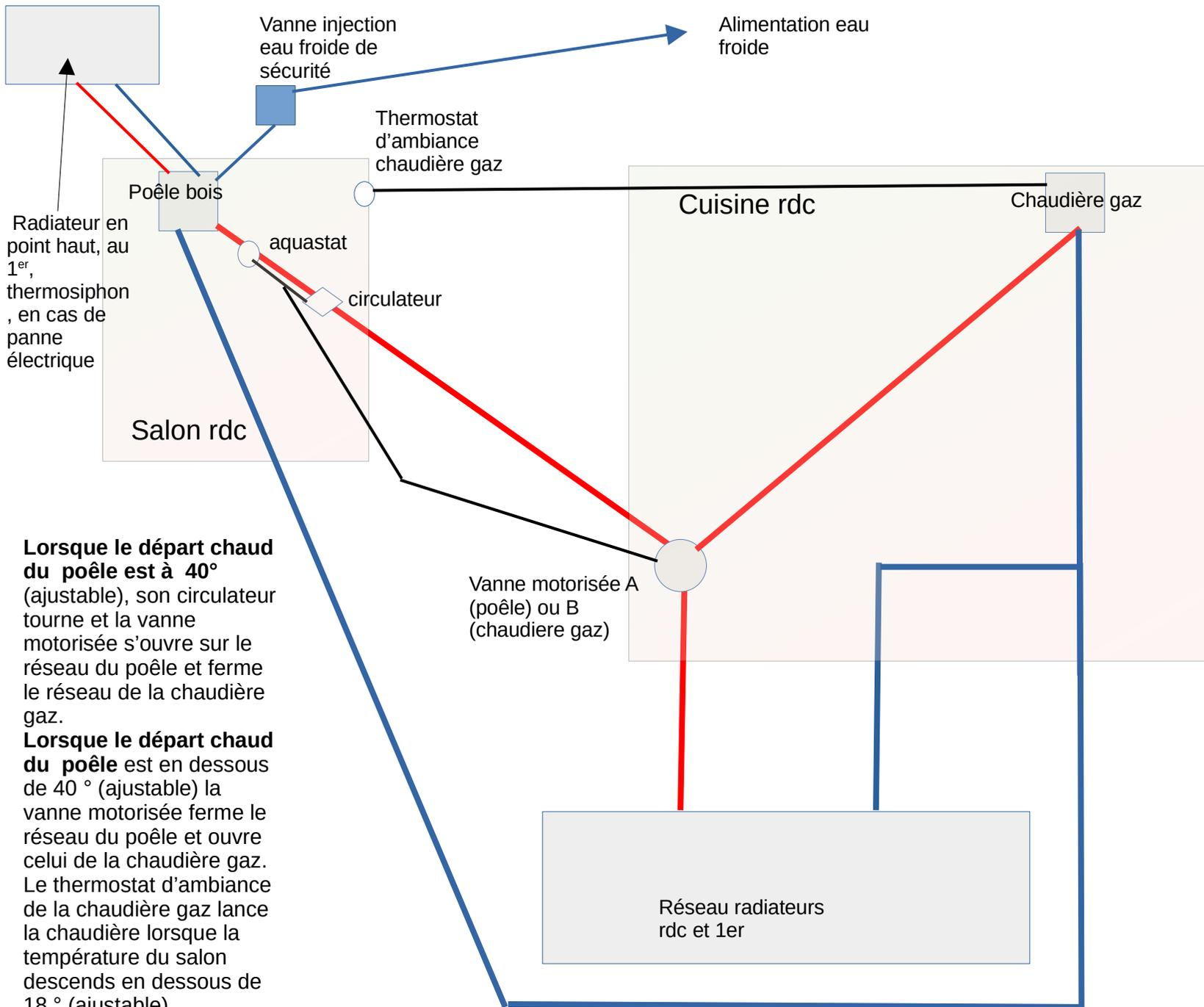
**Lorsque le départ chaud du poêle est à 40°** (ajustable), son circulateur tourne et la vanne motorisée s'ouvre sur le réseau du poêle et ferme le réseau de la chaudière gaz.
