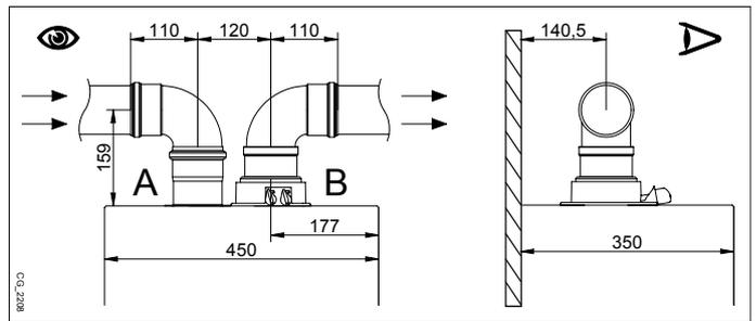
Le coude à 90° permet de raccorder la chaudière aux conduits d'évacuation et d'aspiration selon les différentes exigences. Il peut également être utilisé comme coude supplémentaire à accoupler au conduit ou au coude à 45°
