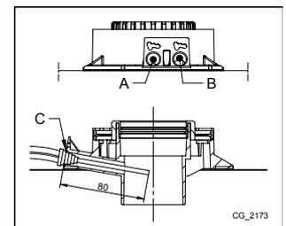
La température de l'air comburant doit être relevée dans la prise raccordée au circuit d'aspiration de l'air (**B**), en introduisant la sonde de mesure pour environ 8 cm (**C**).
