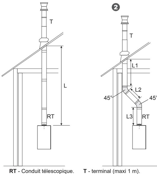
RT - Conduit télescopique. T - terminal (maxi 1 m).
