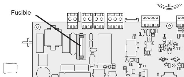
fig. 32 - Remplacement du fusible
