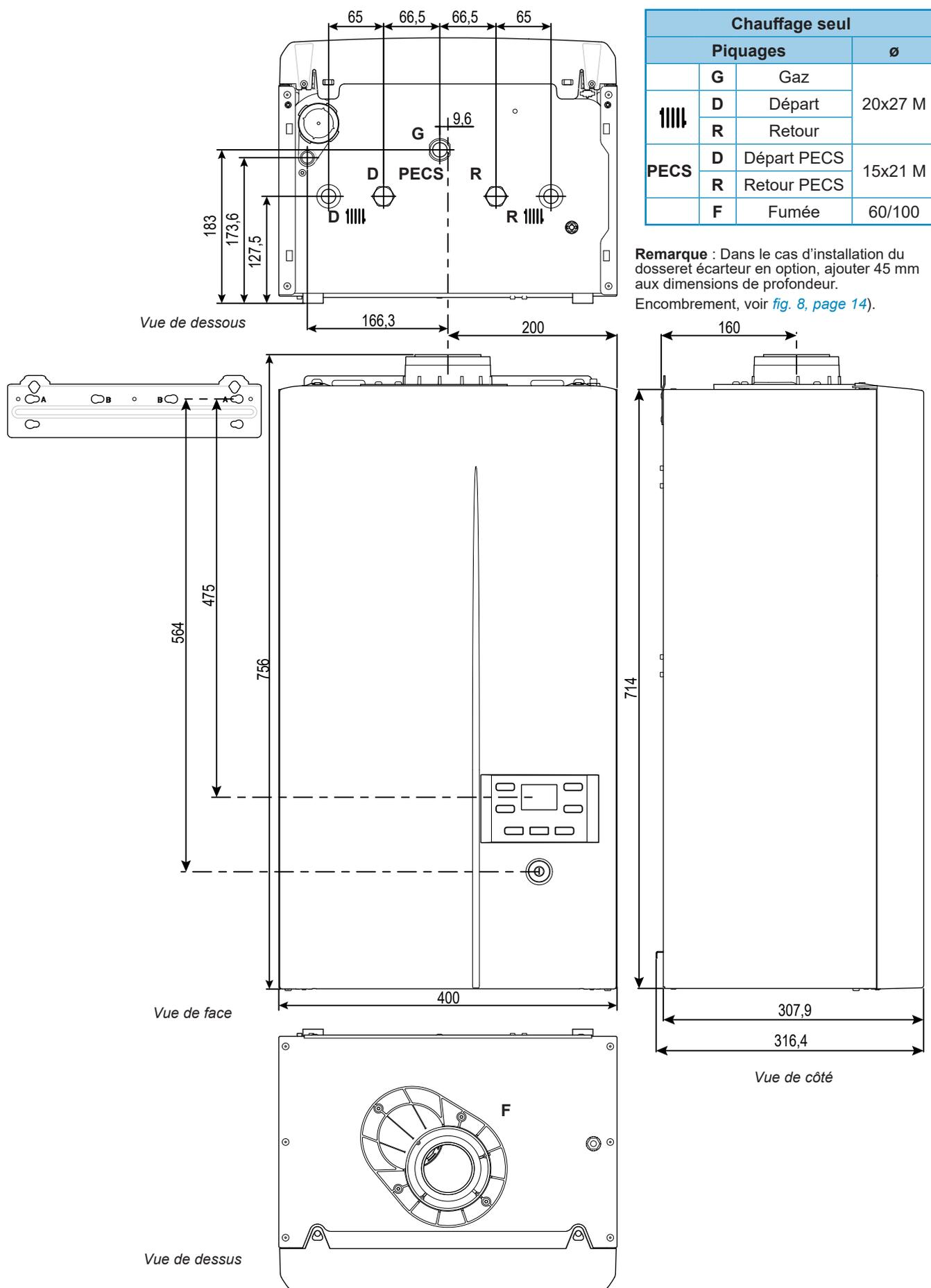
fig. 3 - Dimensions - Chauffage seul ( en mm)
