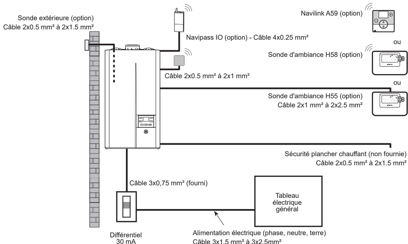
fig. 20 - Schéma d'ensemble des raccordements électriques
