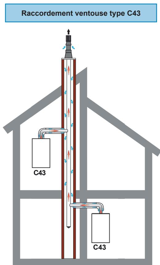
fig. 11 - Possibilités de raccordement (type 43)
