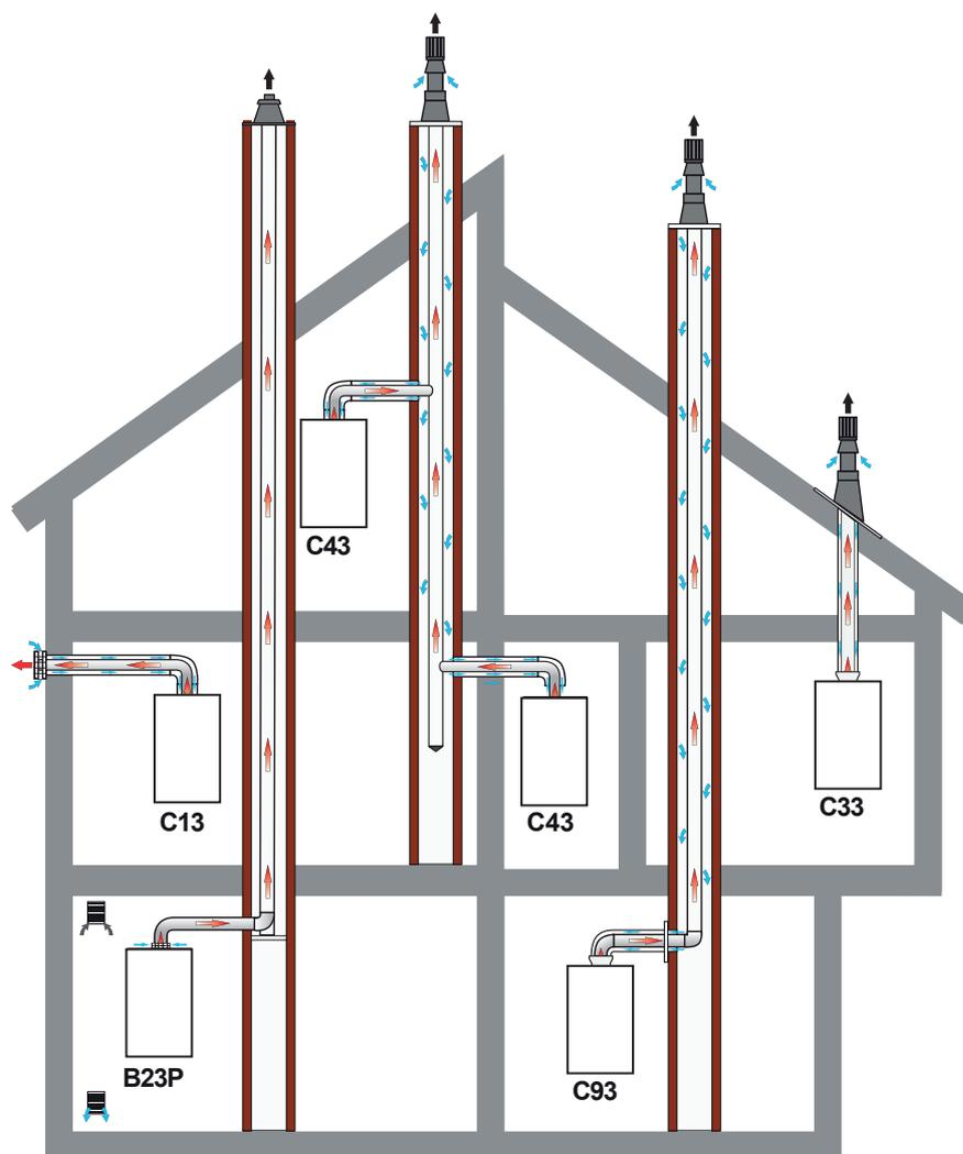
Les raccordements des conduits (concentriques ou cheminée) doivent être parfaitement étanches.
