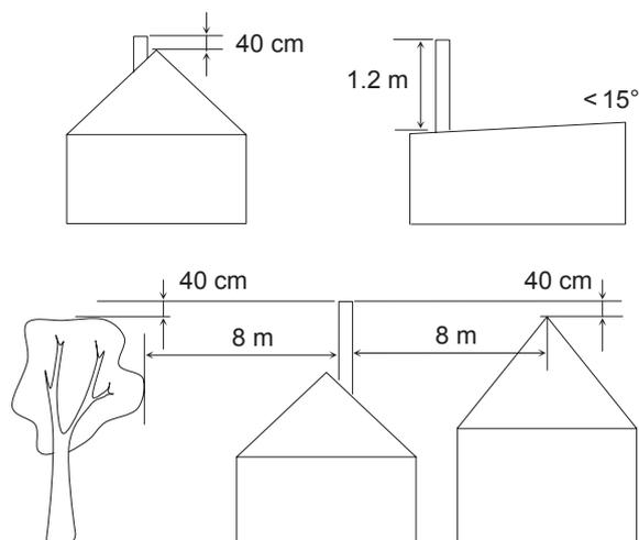
fig. 12 - Hauteur de la souche du conduit d'évacuation (B23, B23p)
