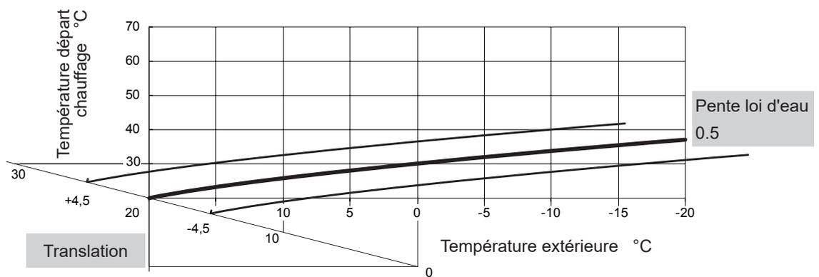
fig. 26 - Translation de la courbe de chauffe (Paramètres 31 / 41)
