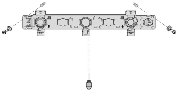
**3** Raccorder les douilles de l'installation en respectant le sens de circulation. Utiliser les joints fournis. Serrer les raccords.
