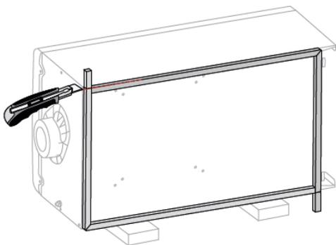
fig. 7 - Pose bandes en mousse
