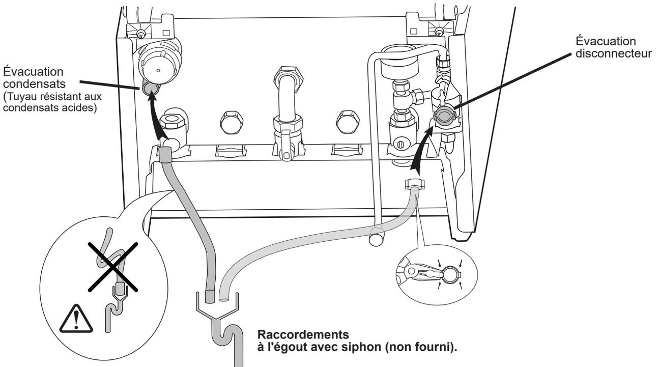
fig. 15 - Raccordements des évacuations
