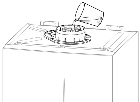
fig. 16 - Remplissage du siphon
