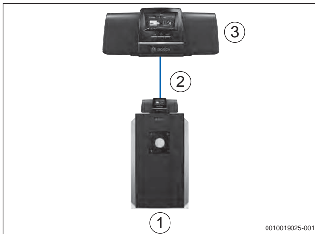
Fig. 31 Commande des chaudières fioul/gaz avec brûleur externe
