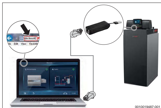
Fig. 77 Servicetool CC 8000 adaptateur USB (côté appareil de régulation) vers IP (côté PC : RJ45)
