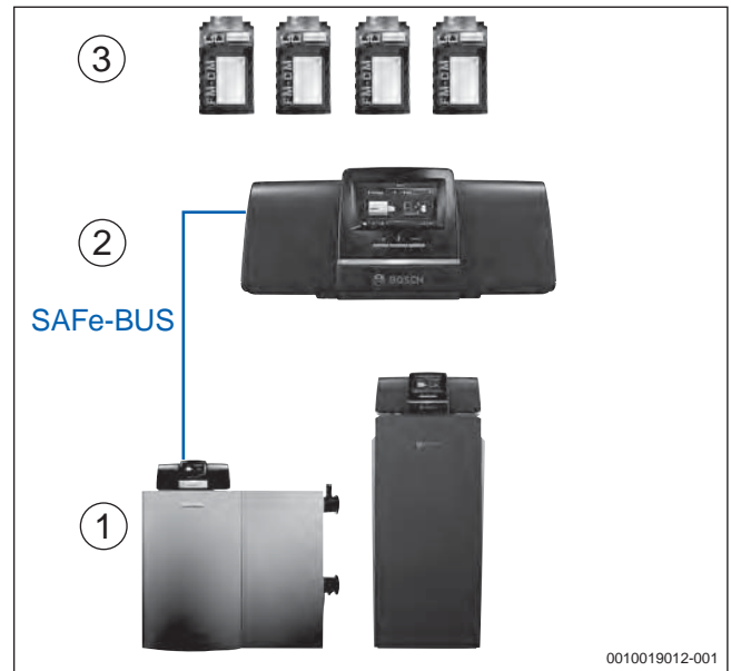
Fig. 14 Montage sur la chaudière : appareil de régulation CC 8313 pour chaudières au sol dans la plage de puissance moyenne, brûleur avec coffret de contrôle de combustion, SAFe de Bosch, montage CC 8000 directement sur la chaudière
