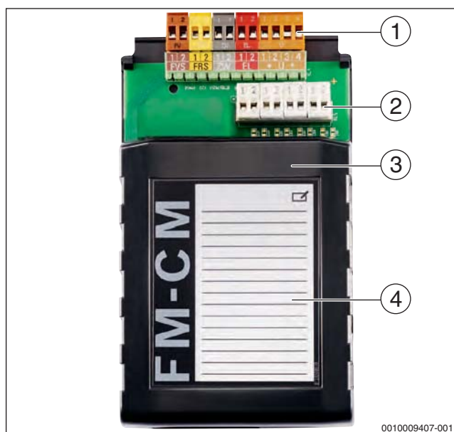
Fig. 61 Module de cascade FM-CM
