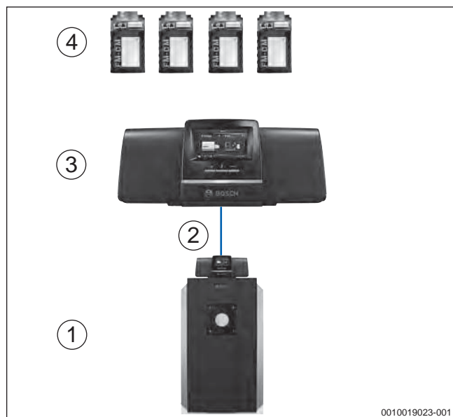
Fig. 29 Appareil de régulation CC 8311 pour chaudières au sol avec brûleur externe
