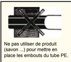
Ne pas utiliser de produit (savon ...) pour mettre en place les embouts du tube PE.
