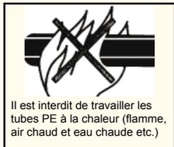
Il est interdit de travailler les tubes PE à la chaleur (flamme, air chaud et eau chaude etc.)
