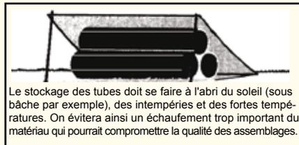
Le stockage des tubes doit se faire à l'abri du soleil (sous bâche par exemple), des intempéries et des fortes températures. On évitera ainsi un échauffement trop important du matériau qui pourrait compromettre la qualité des assemblages.
