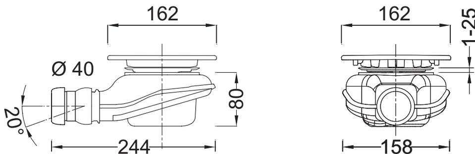
Description : Vidage grand débit, sortie horizontale avec capot ABS. E78260. Collection : HORS COLLECTION. Poids : 0,4 kg. Type d'installation : Mural. Sortie horizontale.
