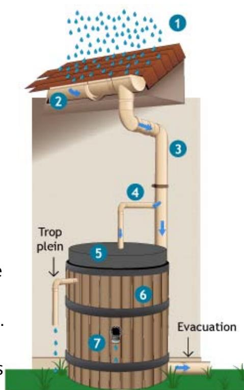
La cuve de récupération peut être installée en hors-sol, la distribution de l'eau se fait alors via un robinet intégré à la cuve ; ou enterrée, la distribution se fait par un pompage.
