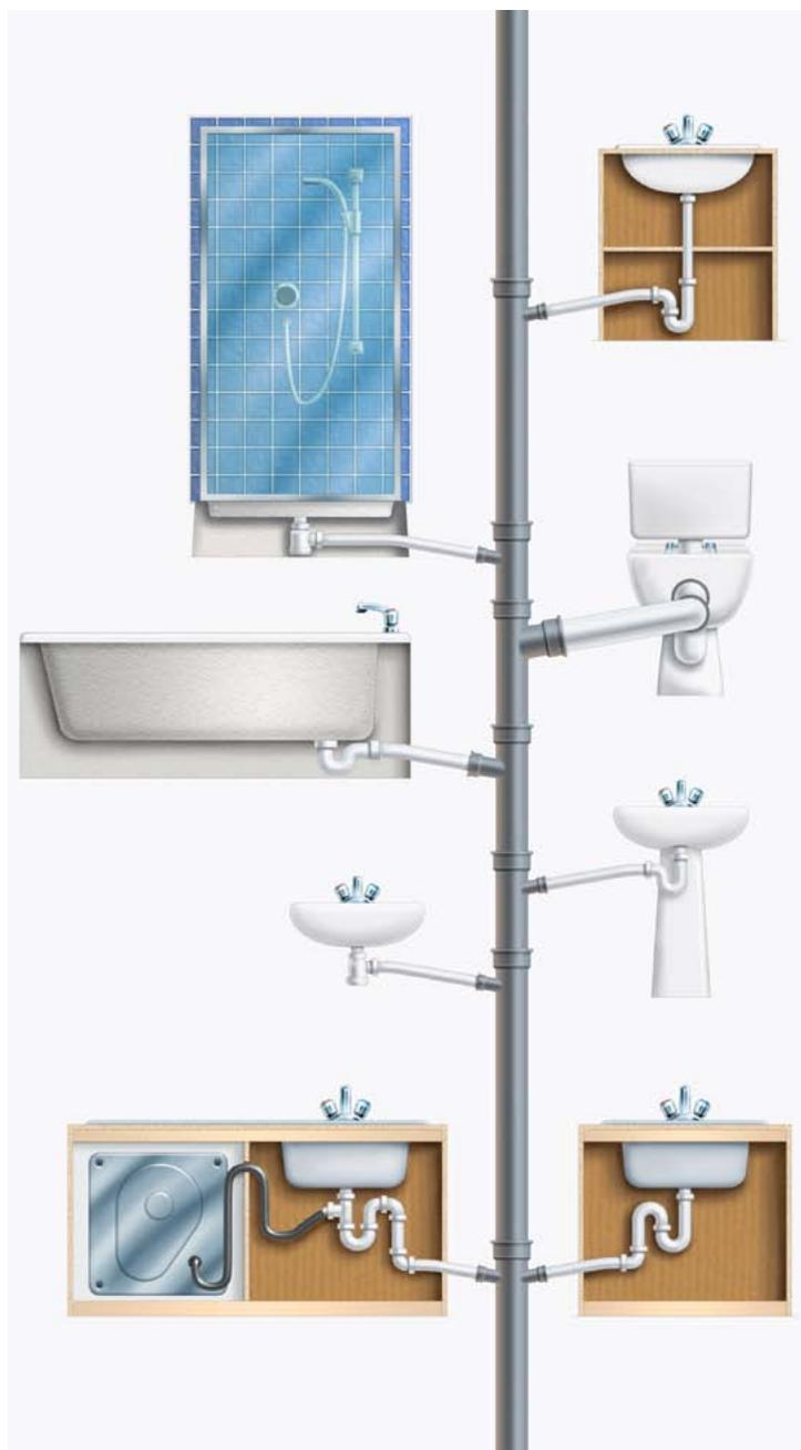
Il existe deux types d'évacuation des eaux usées : la chute séparée et la chute unique.
