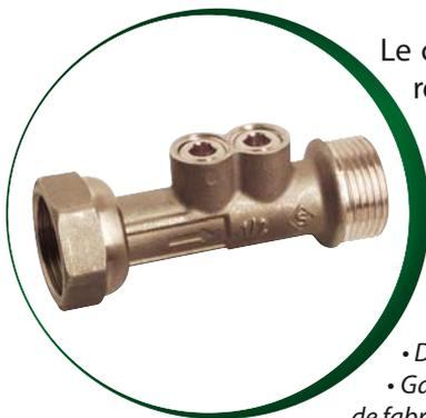
Le clapet anti-pollution PRONORM NF est livré prêt à l'emploi et ne nécessite aucun réglage. Sa double purge permet de nettoyer le clapet en amont et en aval. La pression maximale d'utilisation est de 16 bars, et il est possible de faire circuler de l'eau jusqu'à + 90°C. Ce clapet anti-pollution est multi-positions : il fonctionne aussi bien horizontalement que verticalement.
